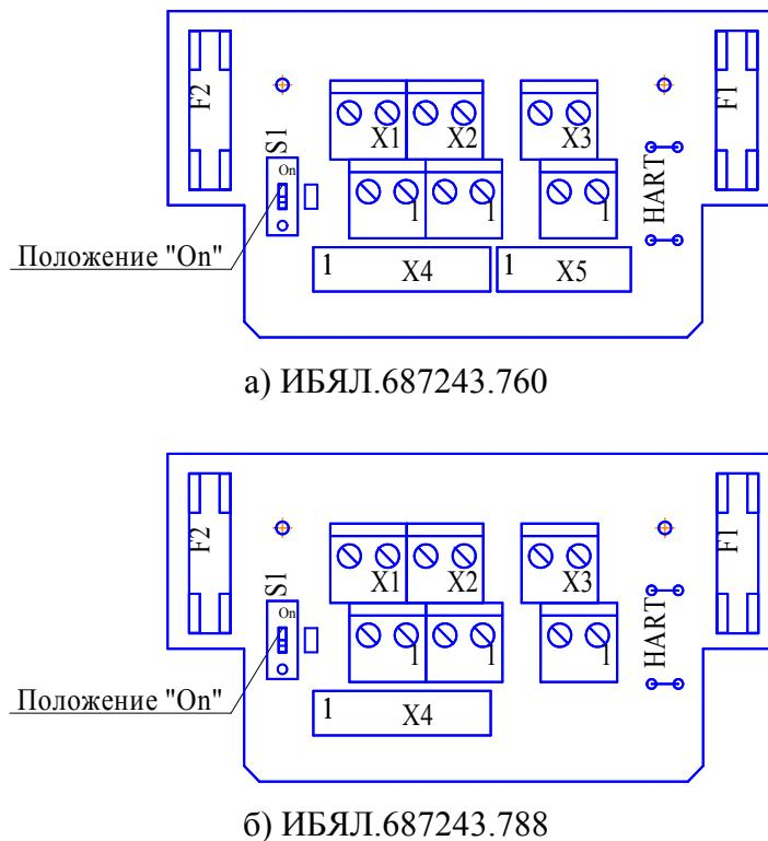
Рисунок 1.3 – Внешний вид платы коммутации
