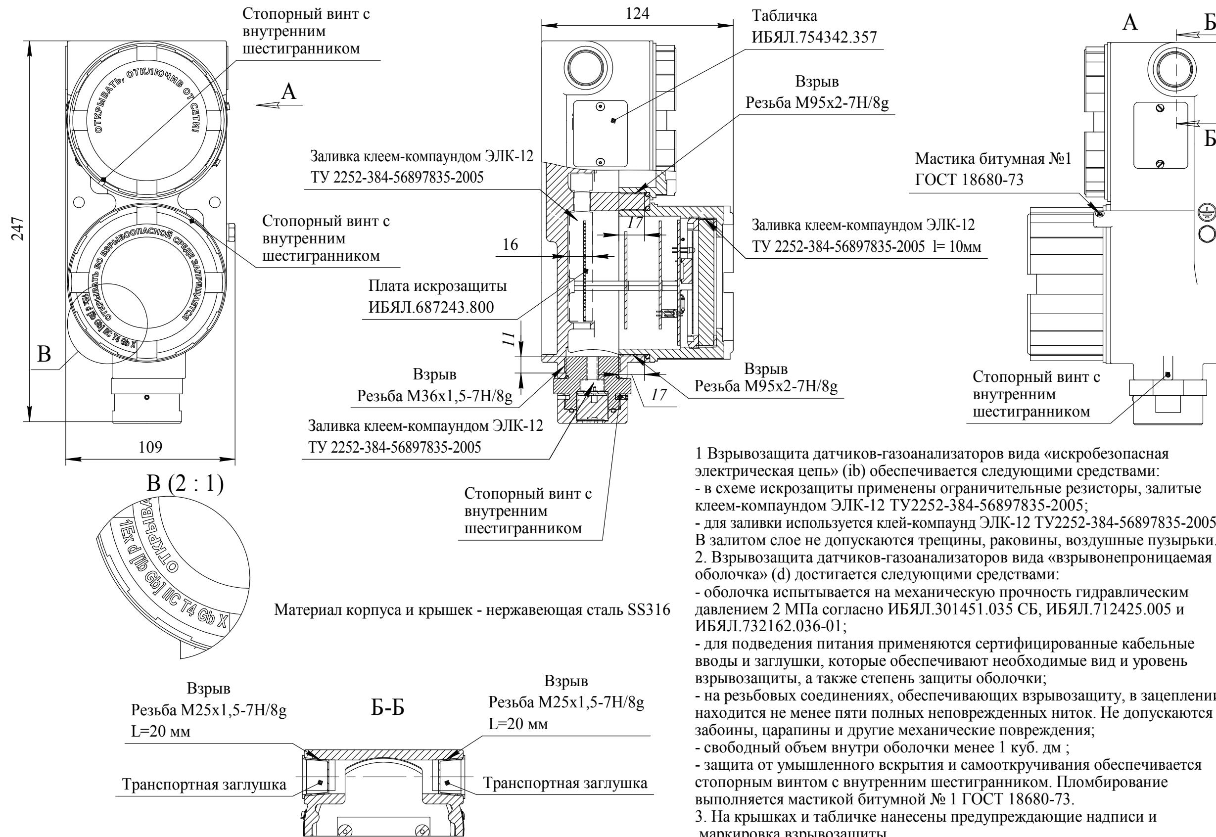
Рисунок Д.3 - Чертеж средств взрывозащиты датчиков-газоанализаторов ИБЯЛ.413445.003-80 (-85)
