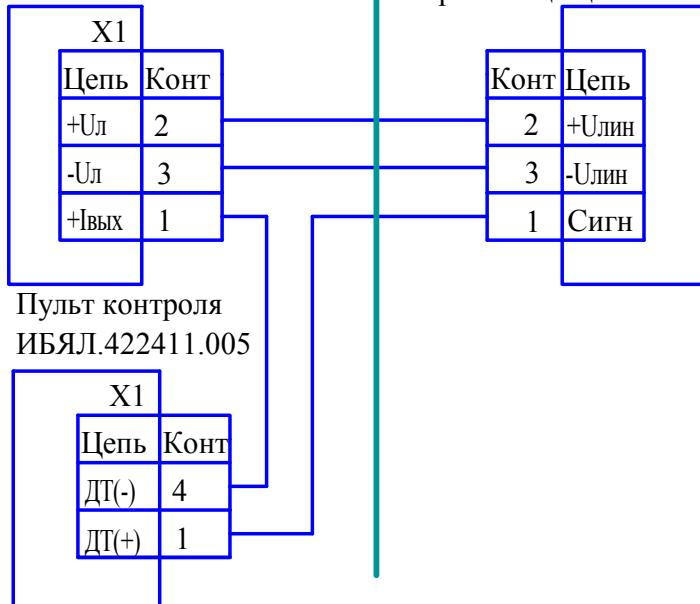
Рисунок Н.2 - Схема подключения
