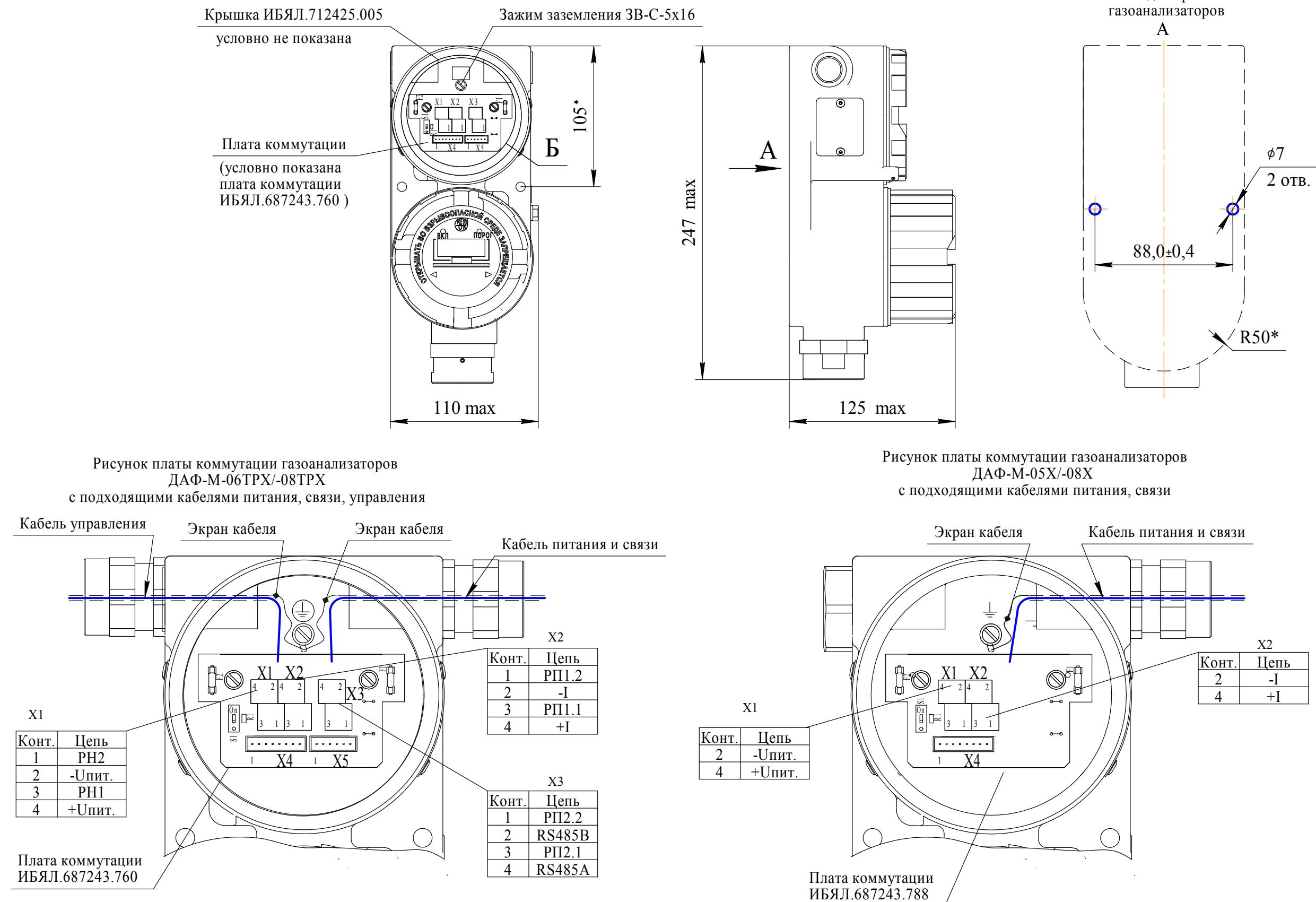
Рисунок К.2 - Монтажный чертеж газоанализаторов ДАФ-М-05Х/-08Х/-06TPX/-08TPX
