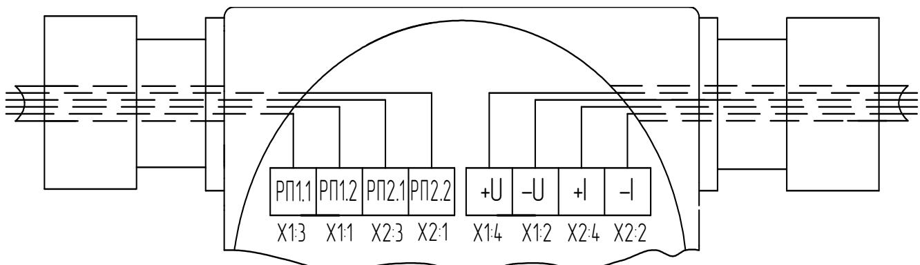
в) подключение линии питания, выходного сигнала постоянного тока и реле
