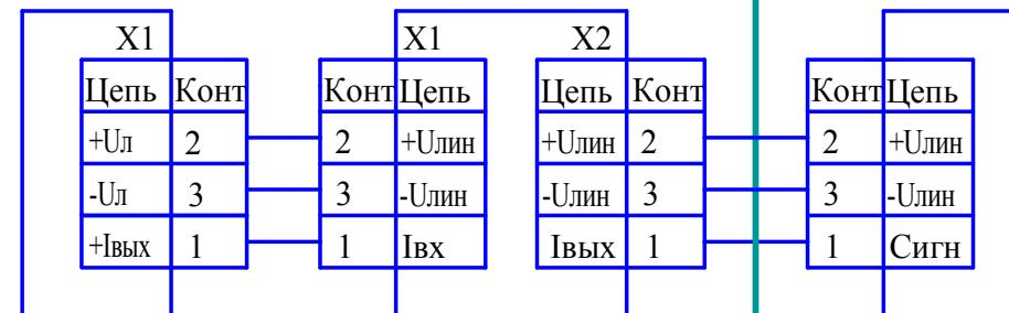
Рисунок Н.3 - Схема подключения блока БМС ИБЯЛ.411531.005 к
