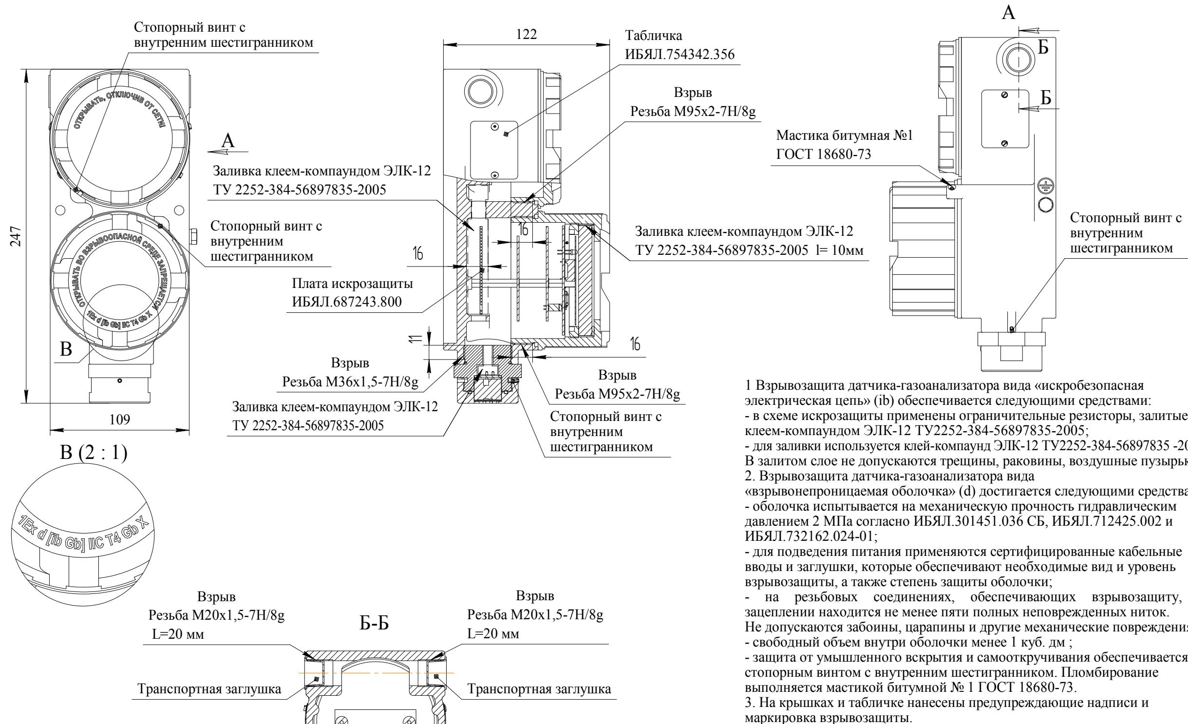
Рисунок Д.2 - Чертеж средств взрывозащиты датчиков-газоанализаторов ИБЯЛ.413445.003-06 (-09)
