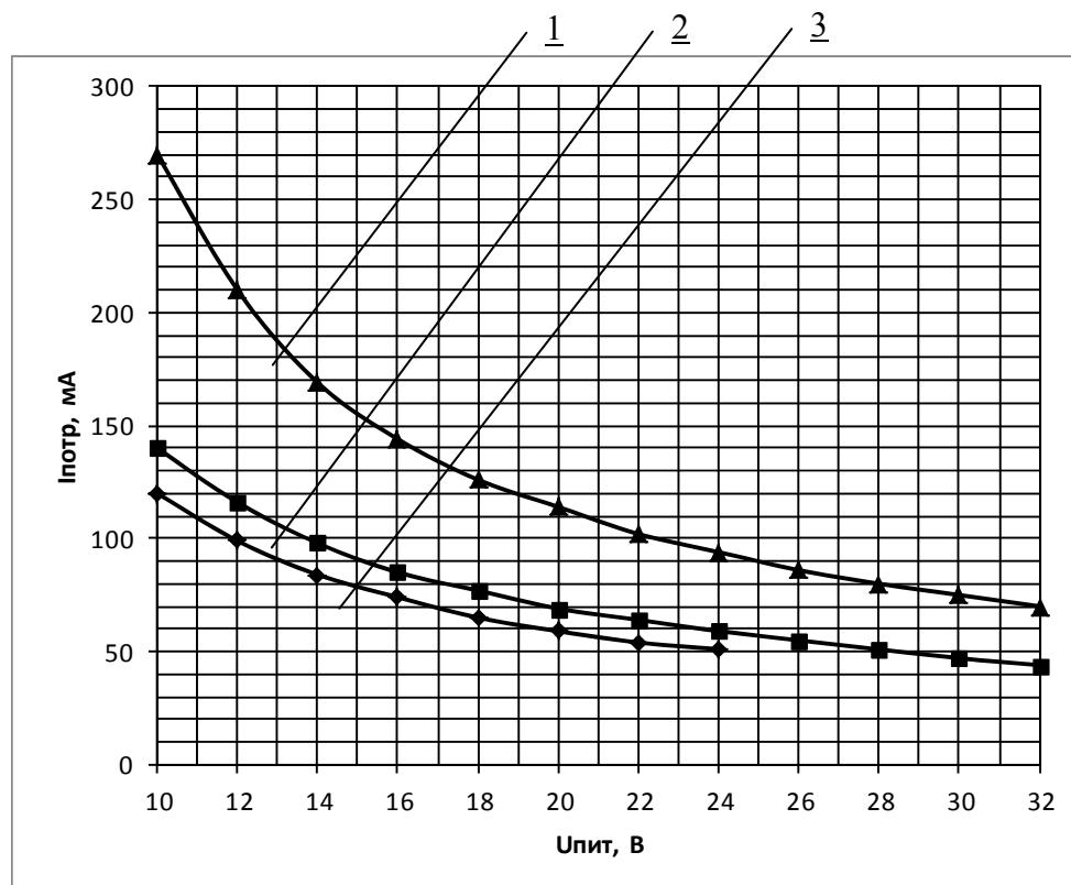
1 — зависимость тока потребления газоанализаторов ИБЯЛ.413445.003-09, -85 при напряжении питания на входе газоанализатора от 10 до 32 В;
