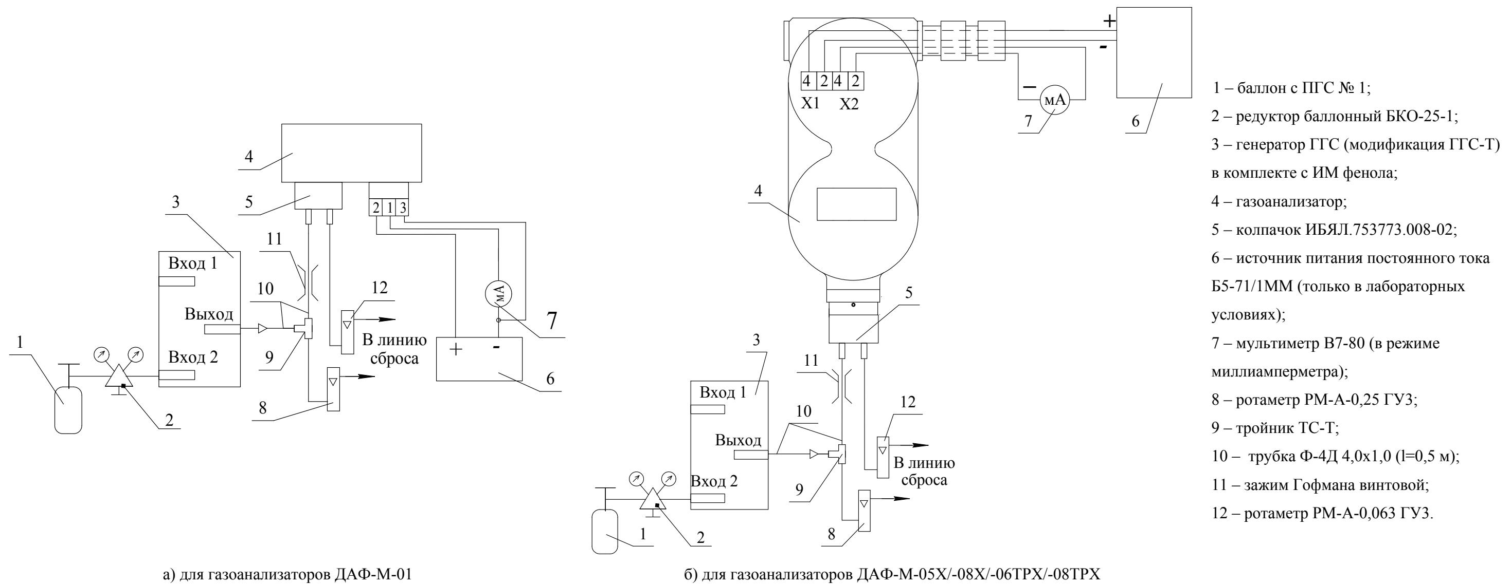
Газовые соединения выполнить трубкой ПВХ 4х1,5.
