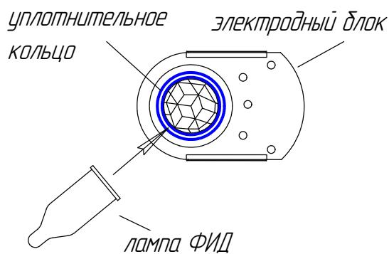
Рисунок 3.5 – Установка лампы ФИД в электродный блок
