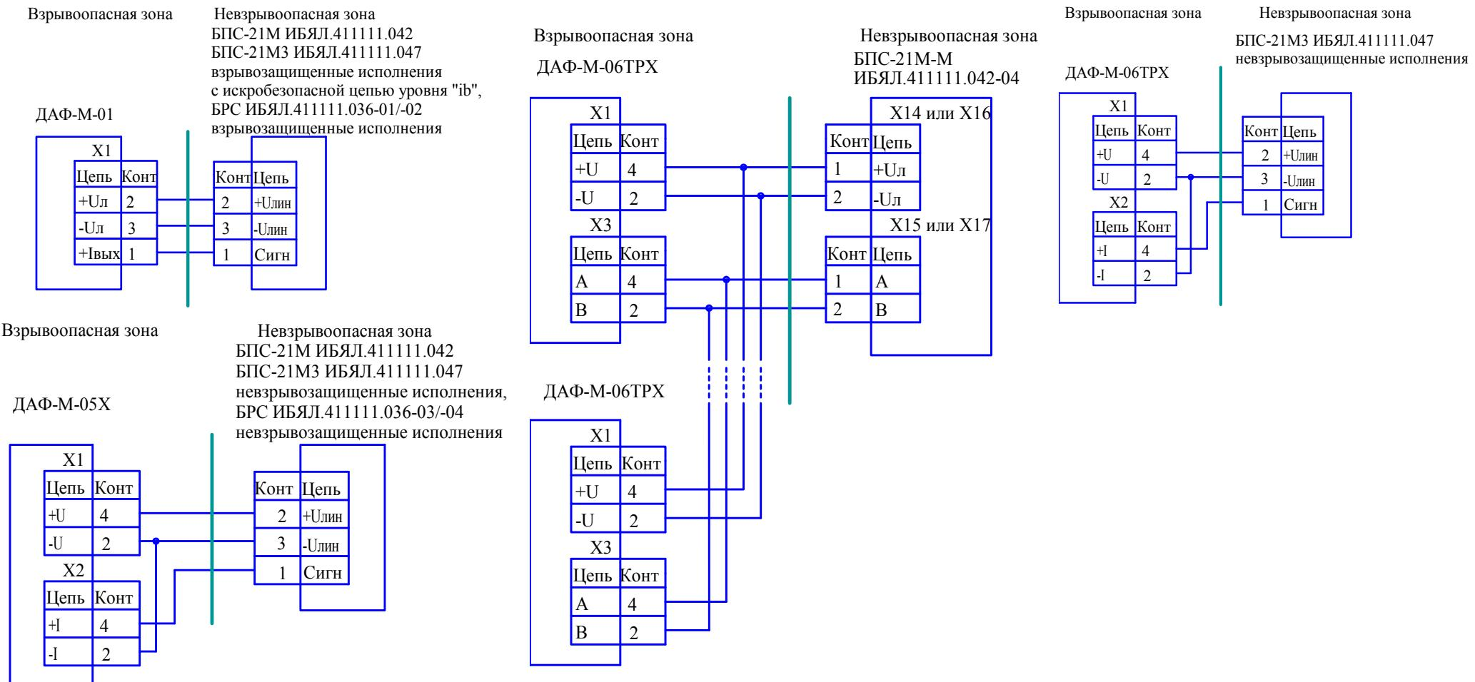
Рисунок Н.1 - Схема подключения газоанализаторов ДАФ-М к блокам БПС-21М3, БПС-21М, БРС
